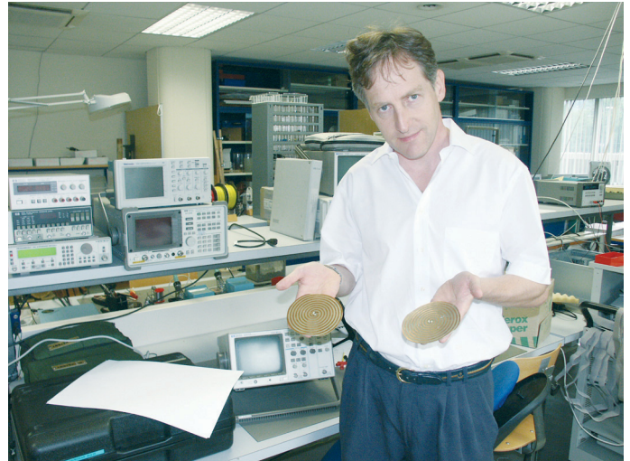
Ricardo Monleone, Geschäftsführer MEET, zeigt Teile der am SUPSI entwickelten planaren Antennen. Antennen-Know how ist eine wichtige Voraussetzung für die Entwicklung von Mikrowellensensoren.
