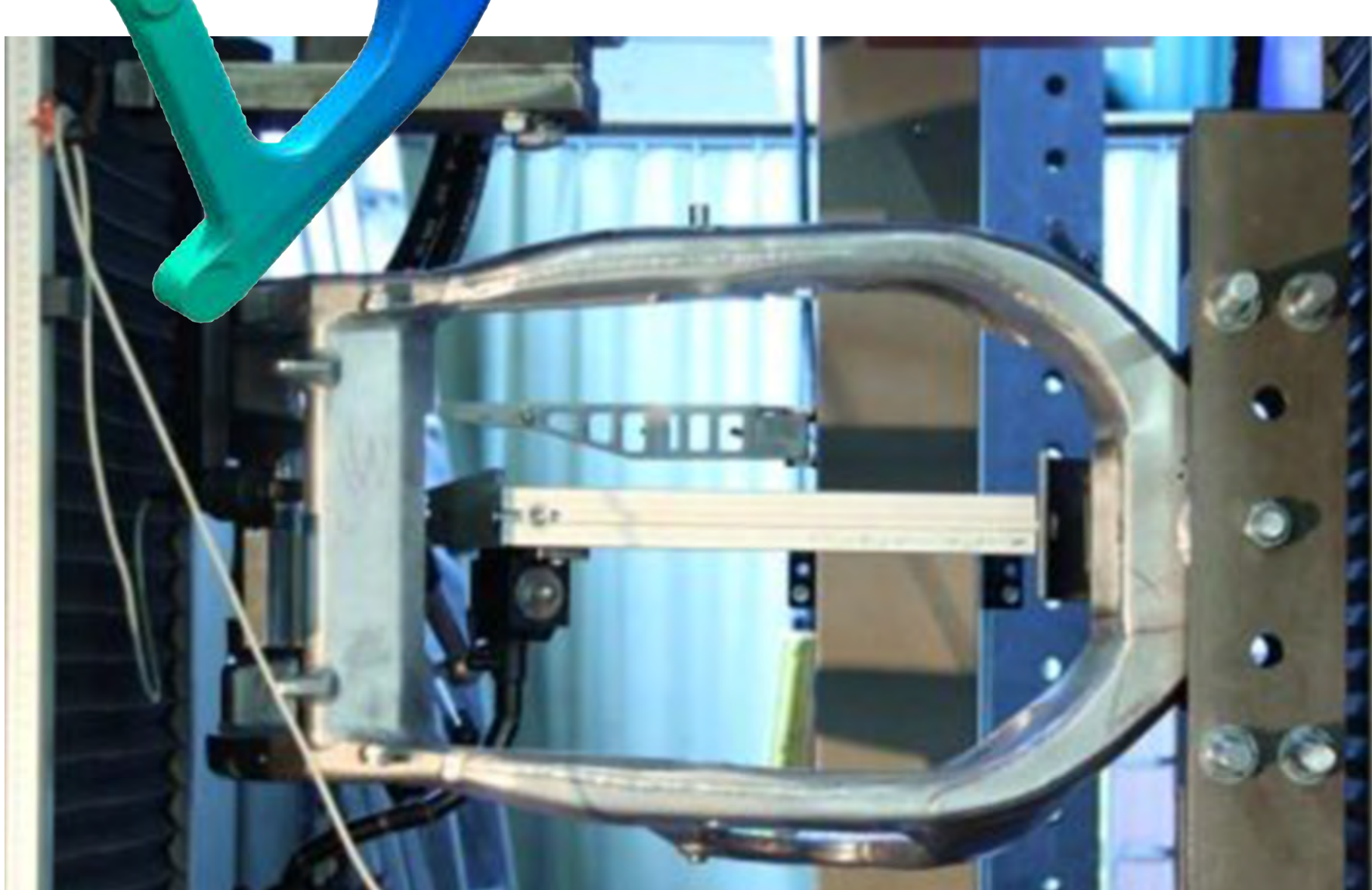
(a) Analisi FEM strutturali (b) misure del telaio al banco prova rigidità
