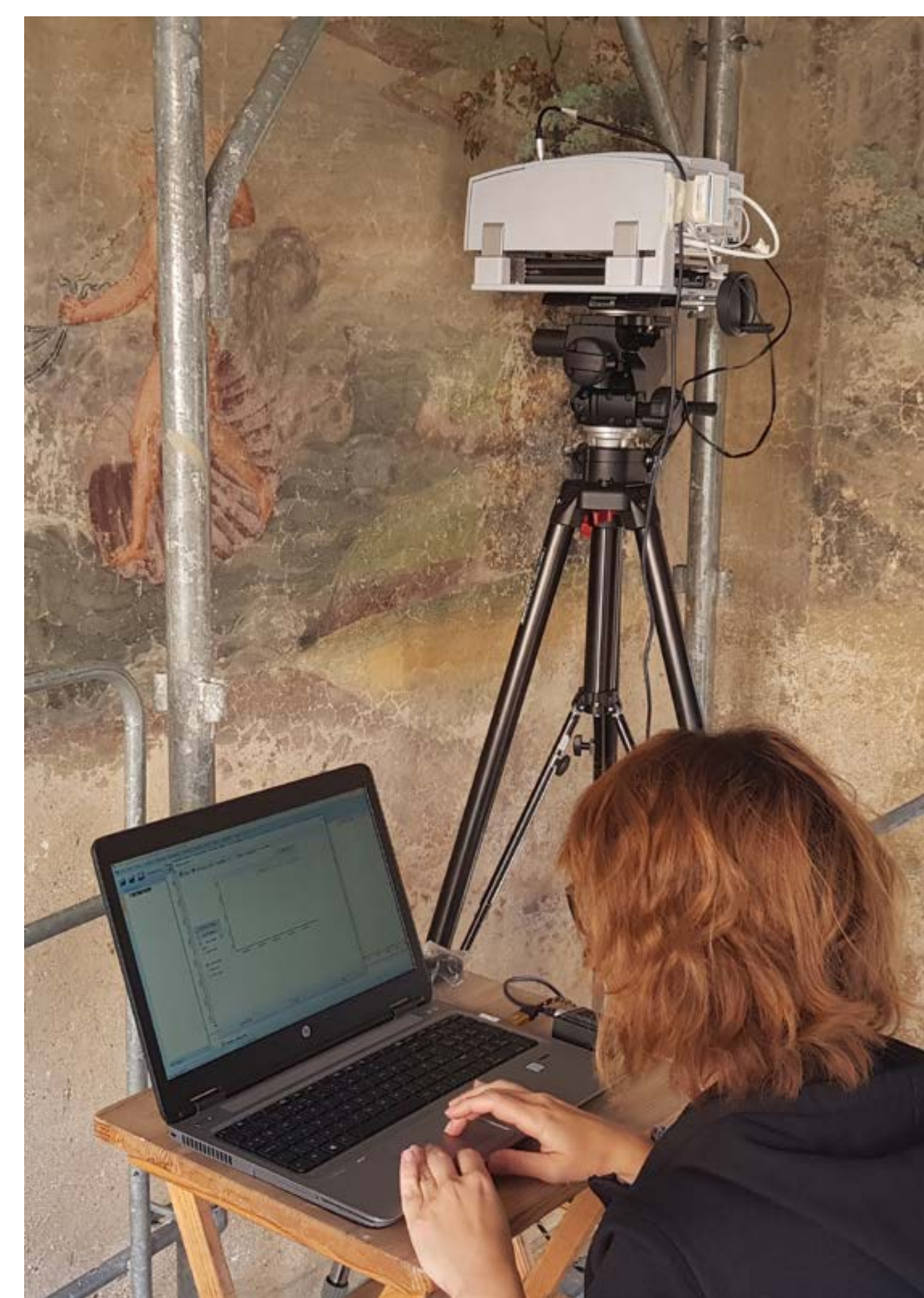
Fig.2 : Campata 1. Indagini con strumentazione FT-IR portatile, 2019.
