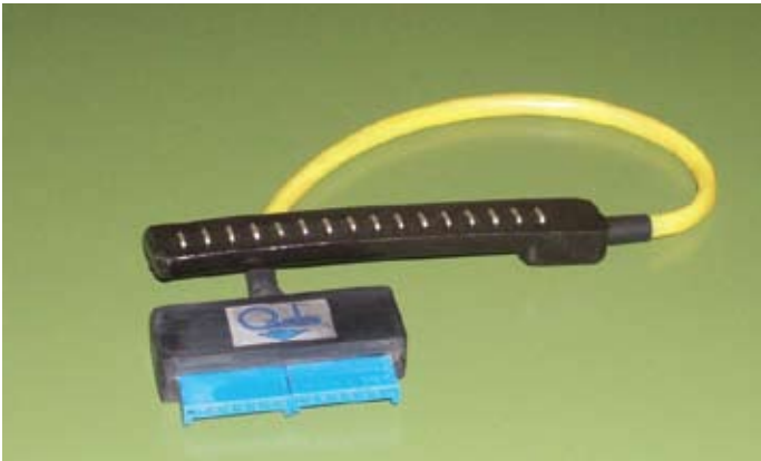
Fig. 3 · Schiera a 16 elettrodi con distanza interelettrodica di 5 mm.
