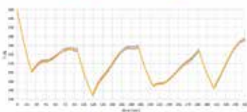
Fig.2 Andamento delle temperature sulle facce di ALSat#1
