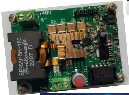
Convertitore DC/DC con dissipatore di calore
