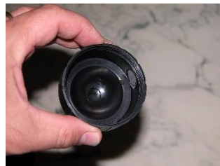
Filtro all'interno della camera
