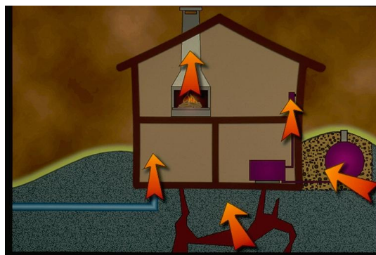
Figura 2: vie di penetrazione del radon (fonte UFSP)
